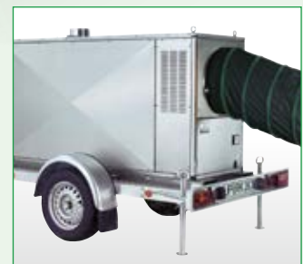
Die Heizzentrale mit Anhänger zugelassen für Straßenbetrieb
